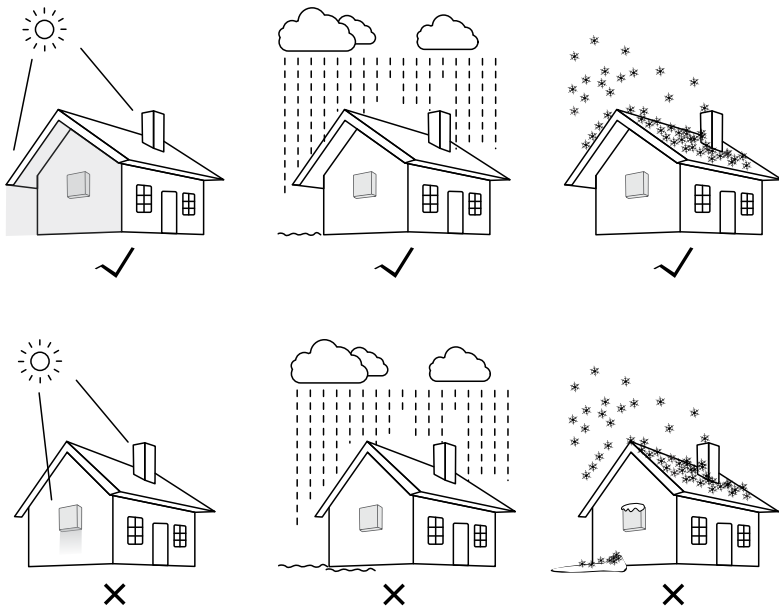
▲ Gambar 4.1 Lokasi instalasi yang di rekomendasikan
