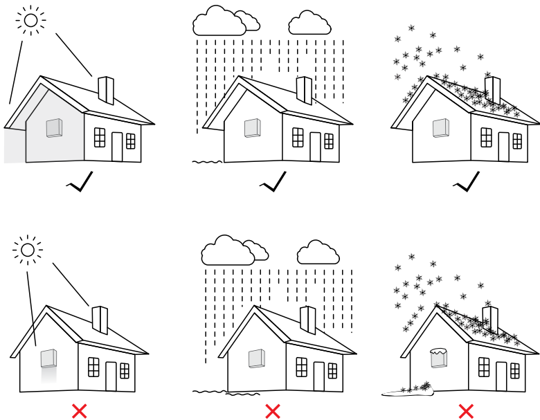
▲ Gambar 4.1 Lokasi instalasi yang di rekomendasikan
