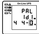
4. Matikan pemutus input unit 1 dan pastikan UPS mati. Nyalakan pemutus input unit 2, akses antarmuka pengaturan LCD, pengaturan mode kerja paralel, ID (NO.2) paralel 4 unit, nomer rudundan dan pengaturan lainnya sama dengan UPS 1
