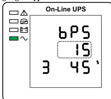
*Pengaturan batas atas tegangan bypass
